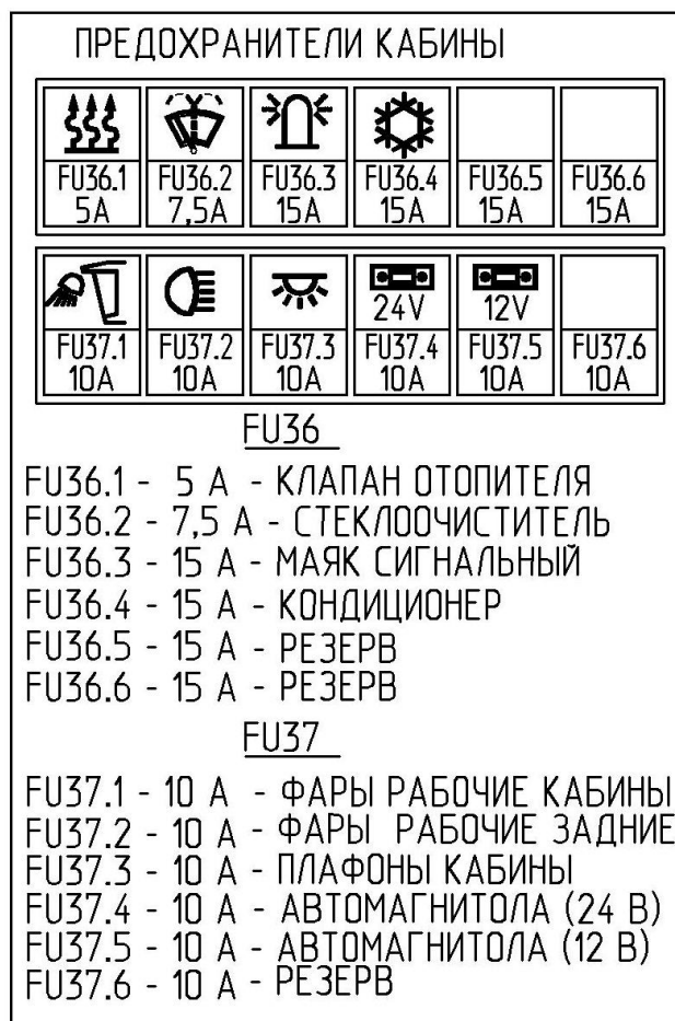
Рисунок 1.13 – Схема соединений предохранителей кабины
