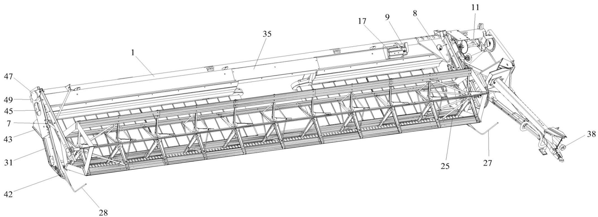
Рисунок 1а – Жатка валковая зерновая ЖВЗ 1000000М; ЖВЗ 2000000М (вид спереди)
