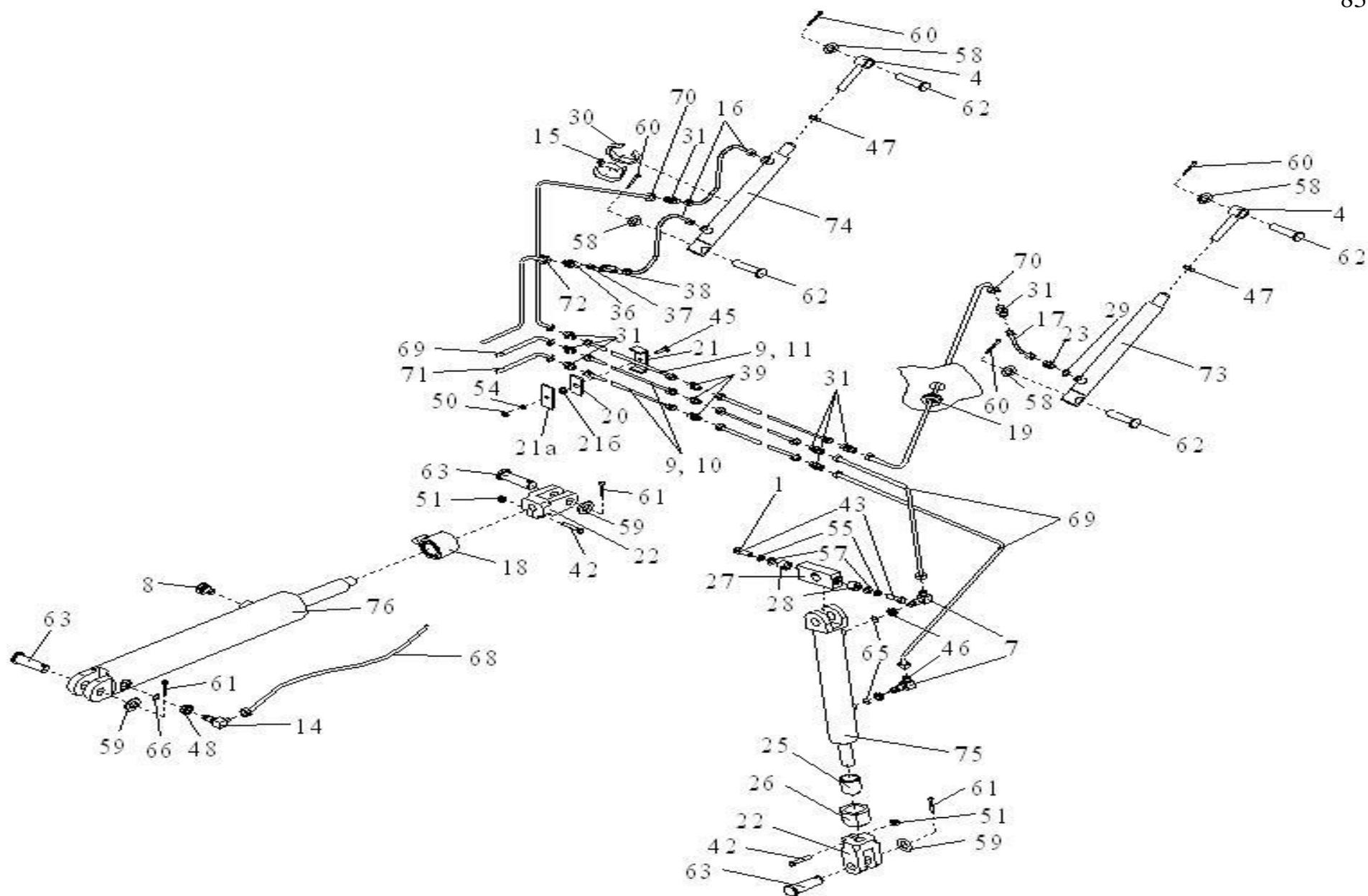
Рисунок 23в – Система гидравлическая ЖВЗ 1800000А, ЖВЗ 2800000А
