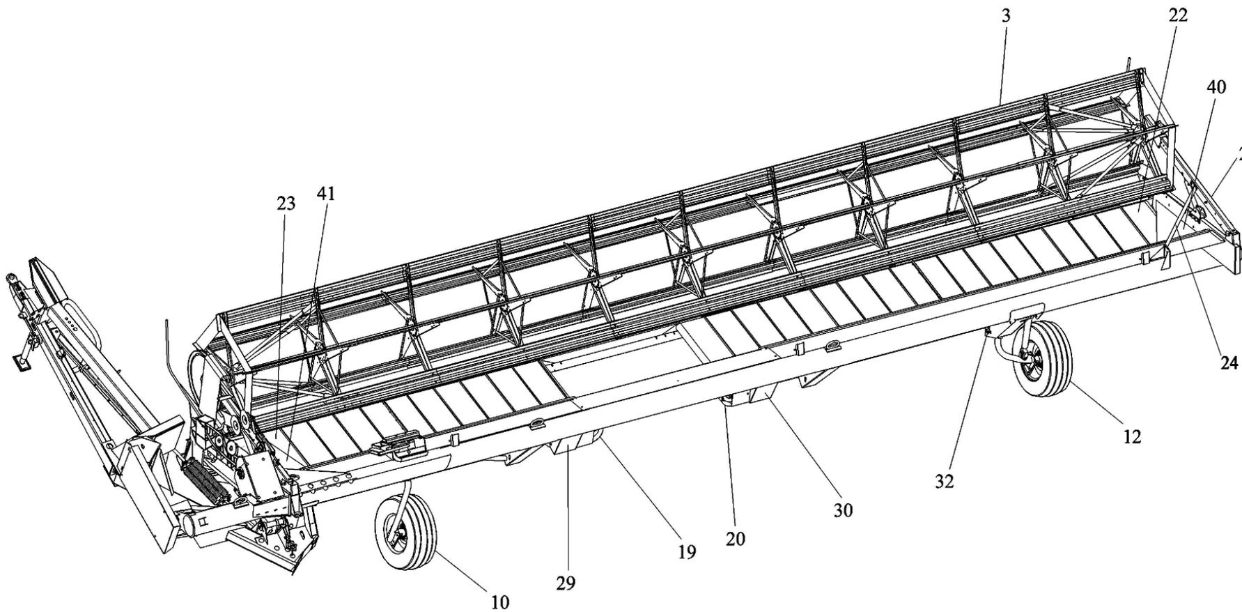
Рисунок 16 – Жатка валковая зерновая ЖВЗ 1000000М; ЖВЗ 2000000М (вид сзади)
