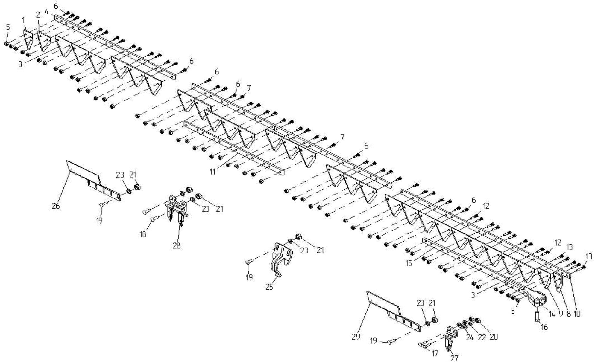
Рисунок 19 – Нож ЖВЗ 1262000А, ЖВЗ 1263000А, ЖВЗ 2260000 и детали режущего аппарата
