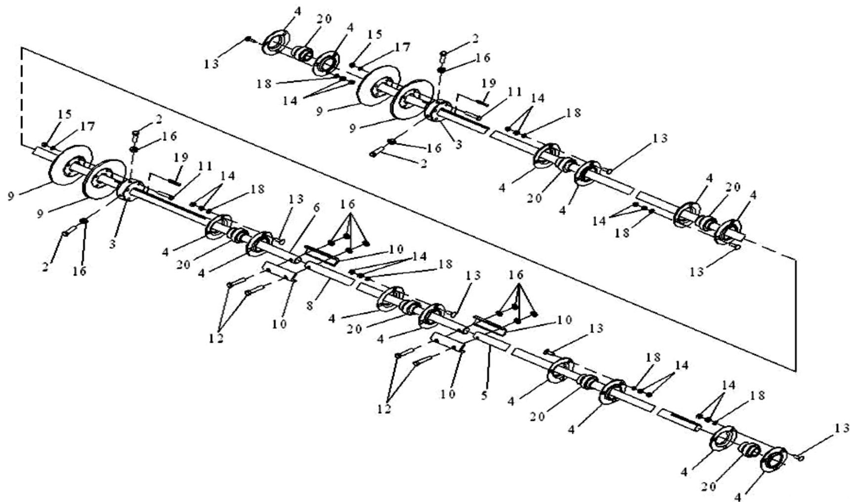
Рисунок 15 – Приводной вал в сборе ЖВЗ 1210000М; ЖВЗ 2210000М
