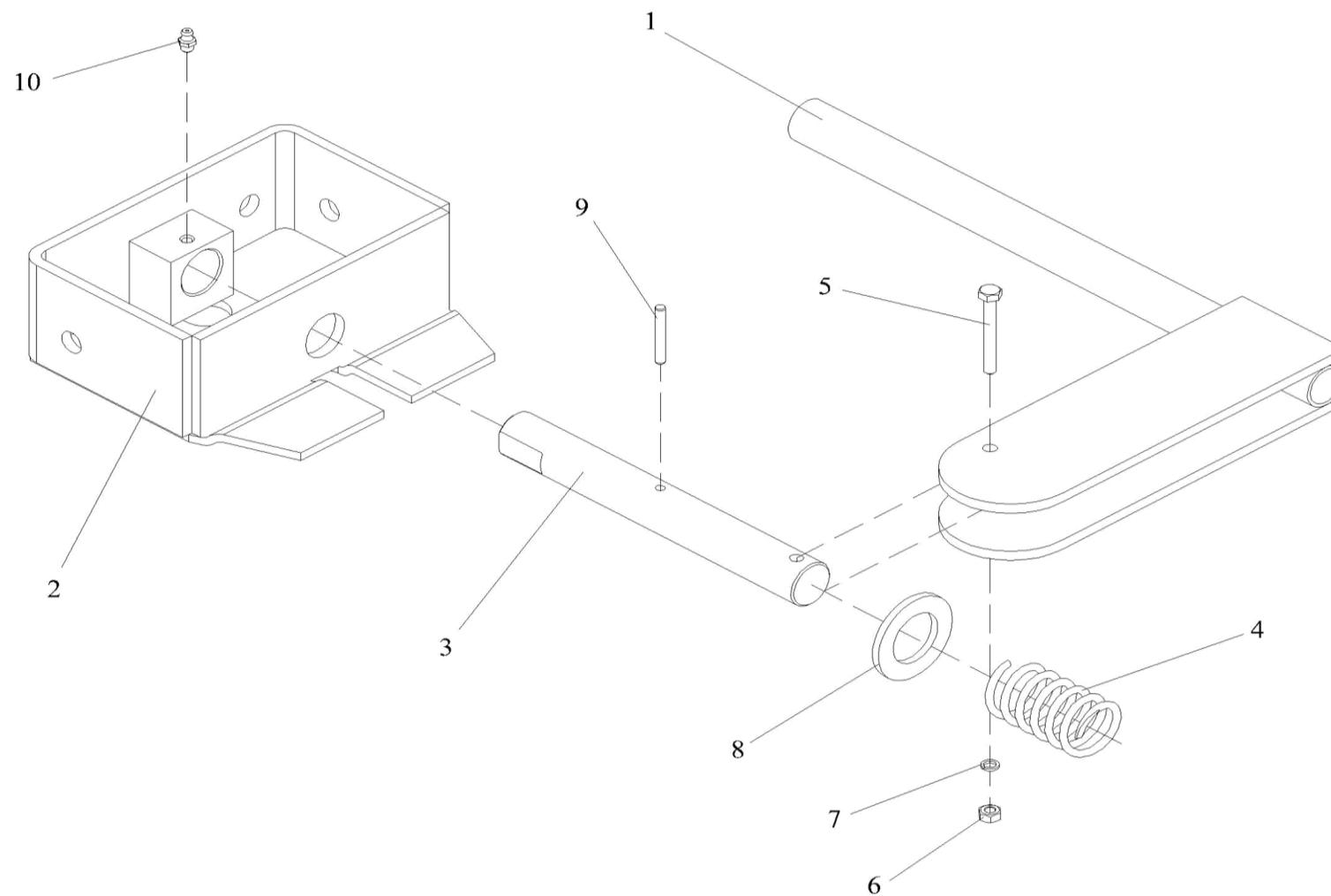
Рисунок 6 – Механизм фиксации колеса ЖВЗ 1090000
