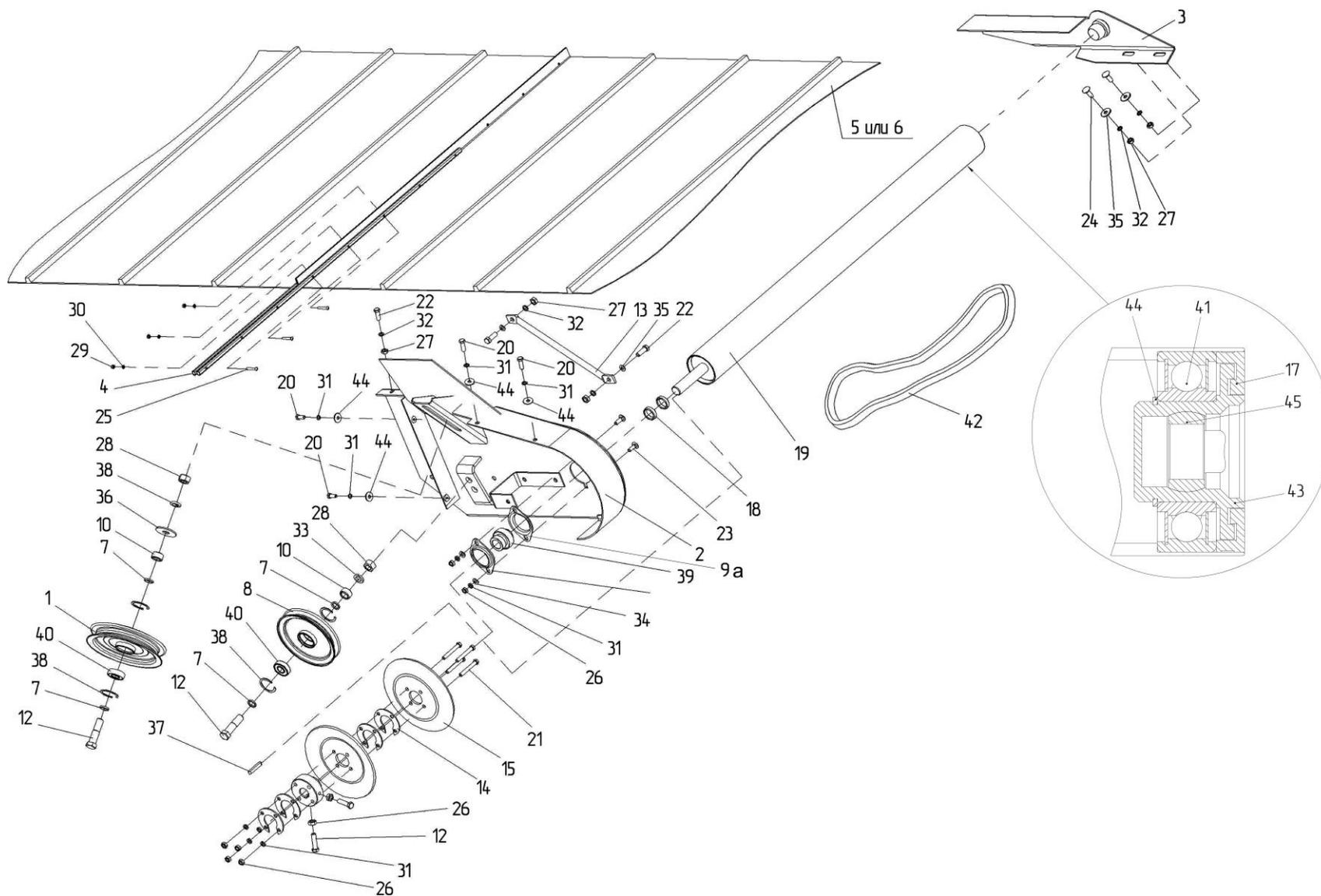
Рисунок 13 – Привод транспортера левый ЖВЗ 1400000М, ЖВЗ 1400000М-02
