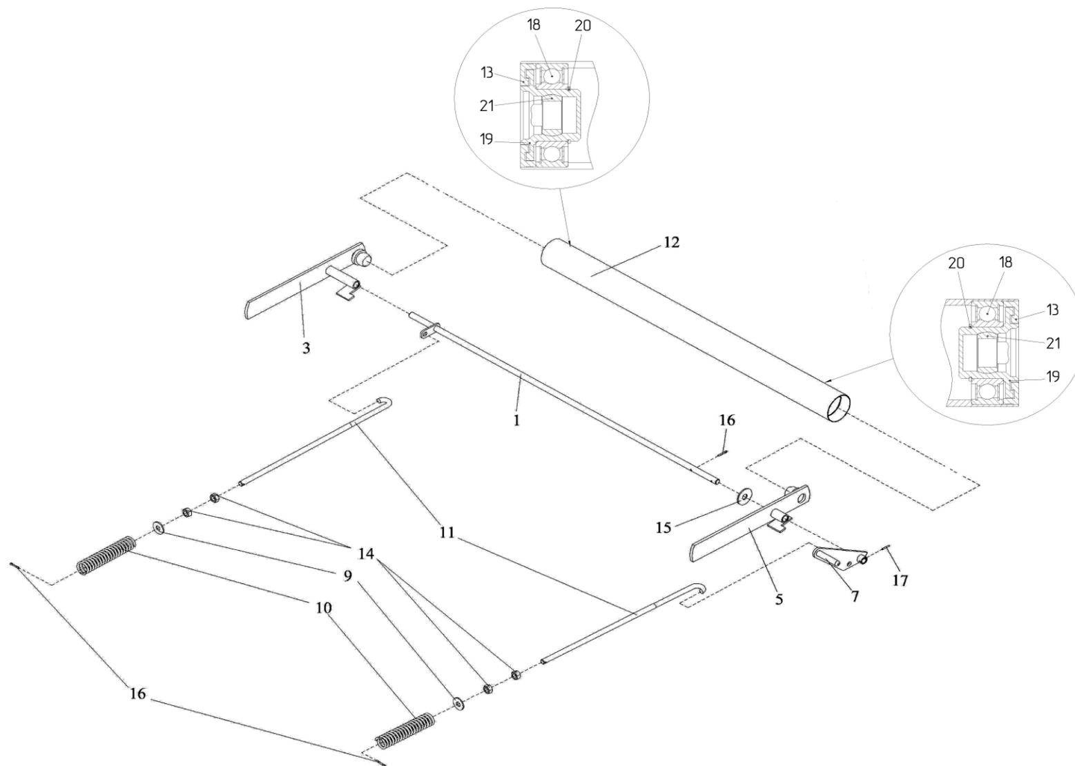
Рисунок 16а – Натяжное устройство ЖВЗ 1220000
