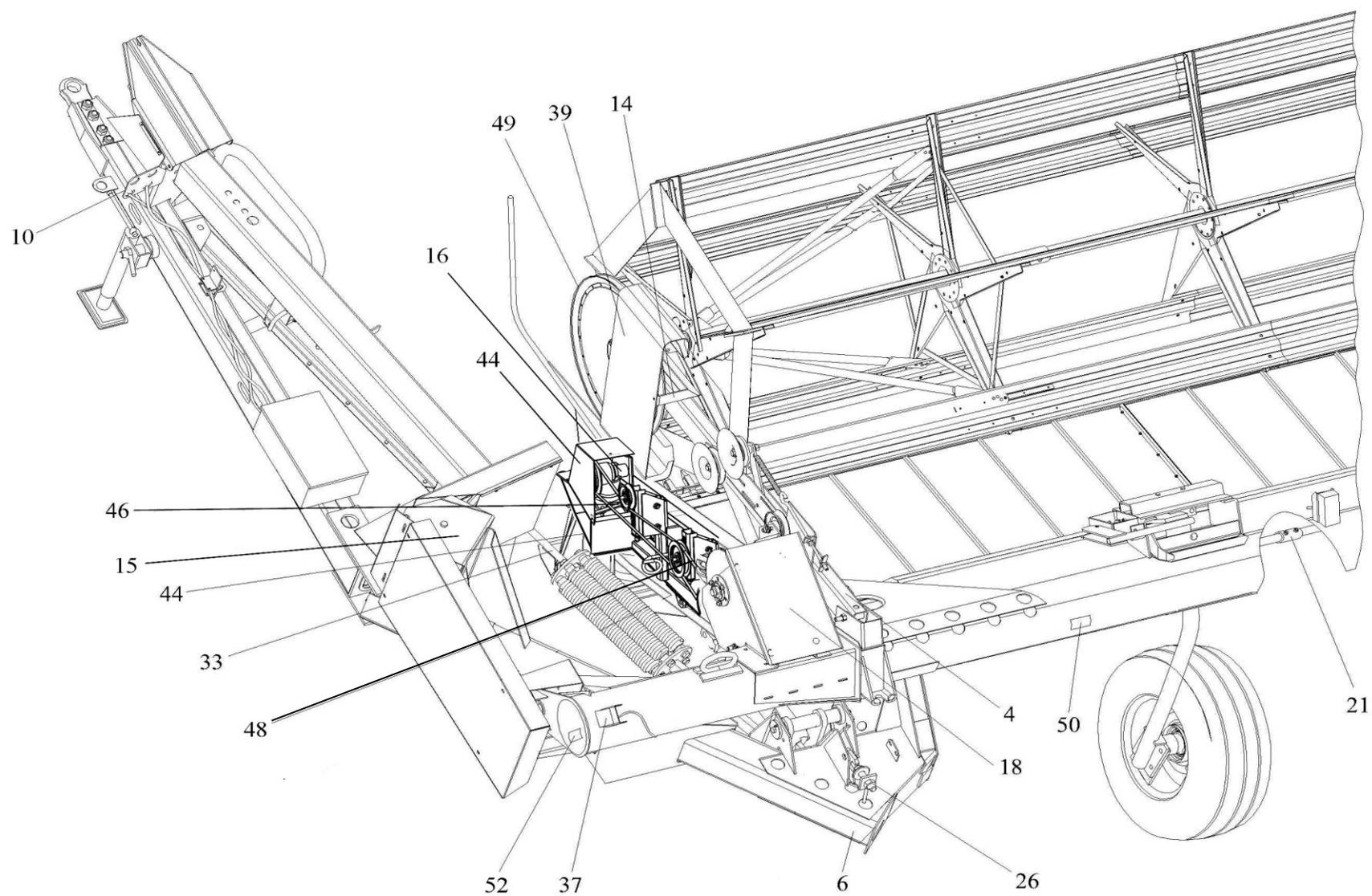
Рисунок 1в – Жатка валковая зерновая ЖВЗ 1000000М; ЖВЗ 2000000М (левая часть)
