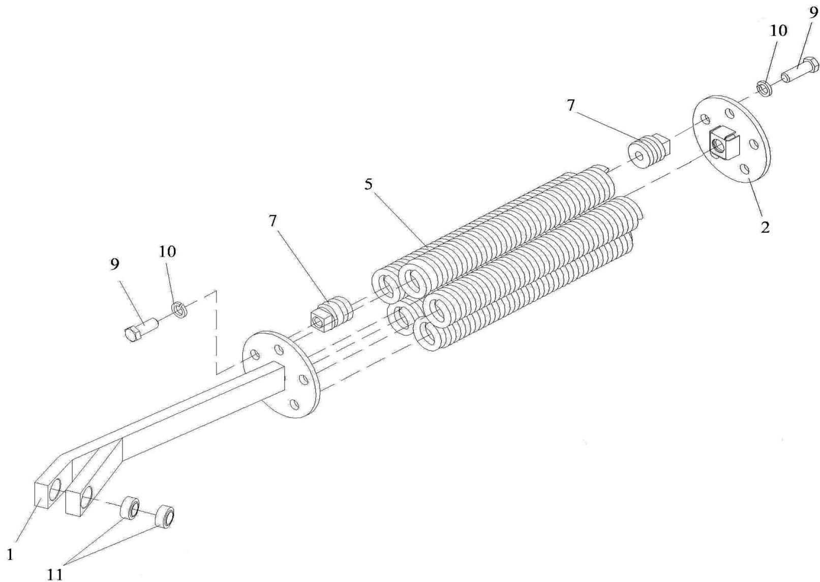
Рисунок 9 – Блок пружин ЖВЗ 1140000, ЖВЗ 1140000-01
