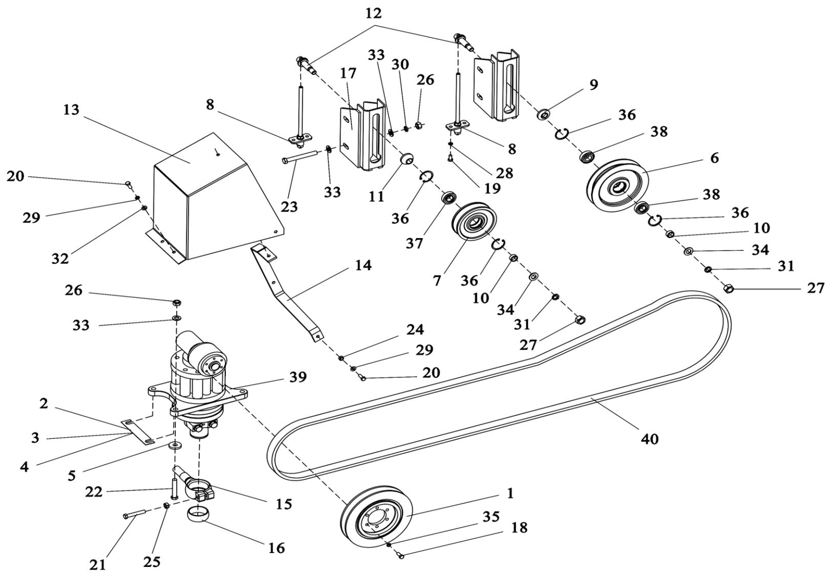
Рисунок 10 – Установка угловой передачи
