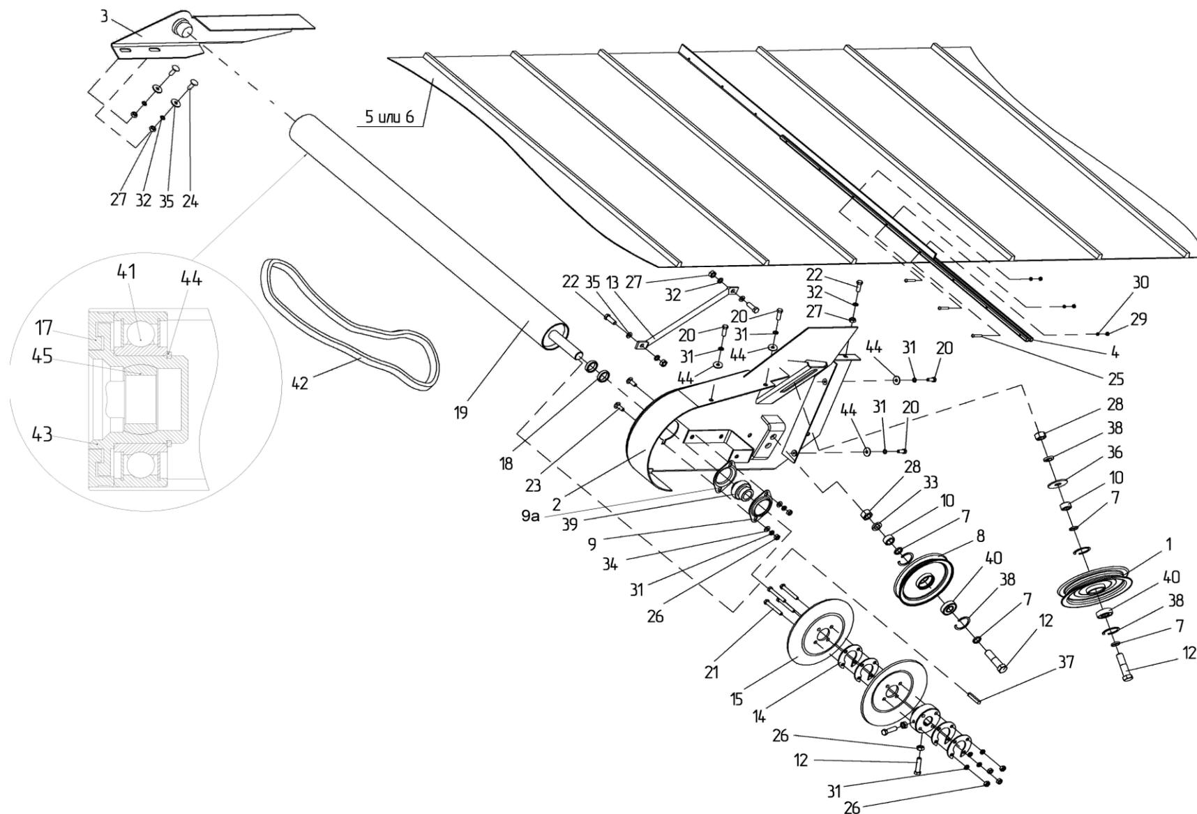
Рисунок 14 – Привод транспортера правый ЖВЗ 1400000М-01, ЖВЗ 1400000М-03
