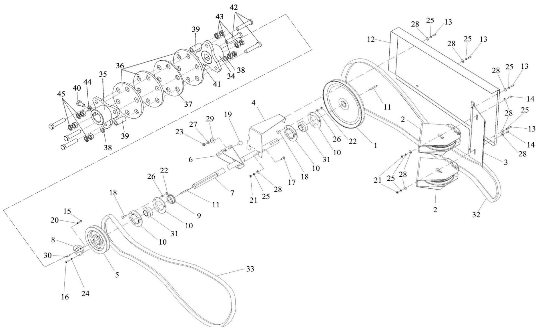
Рисунок 24 – Промежуточный вал в сборе
