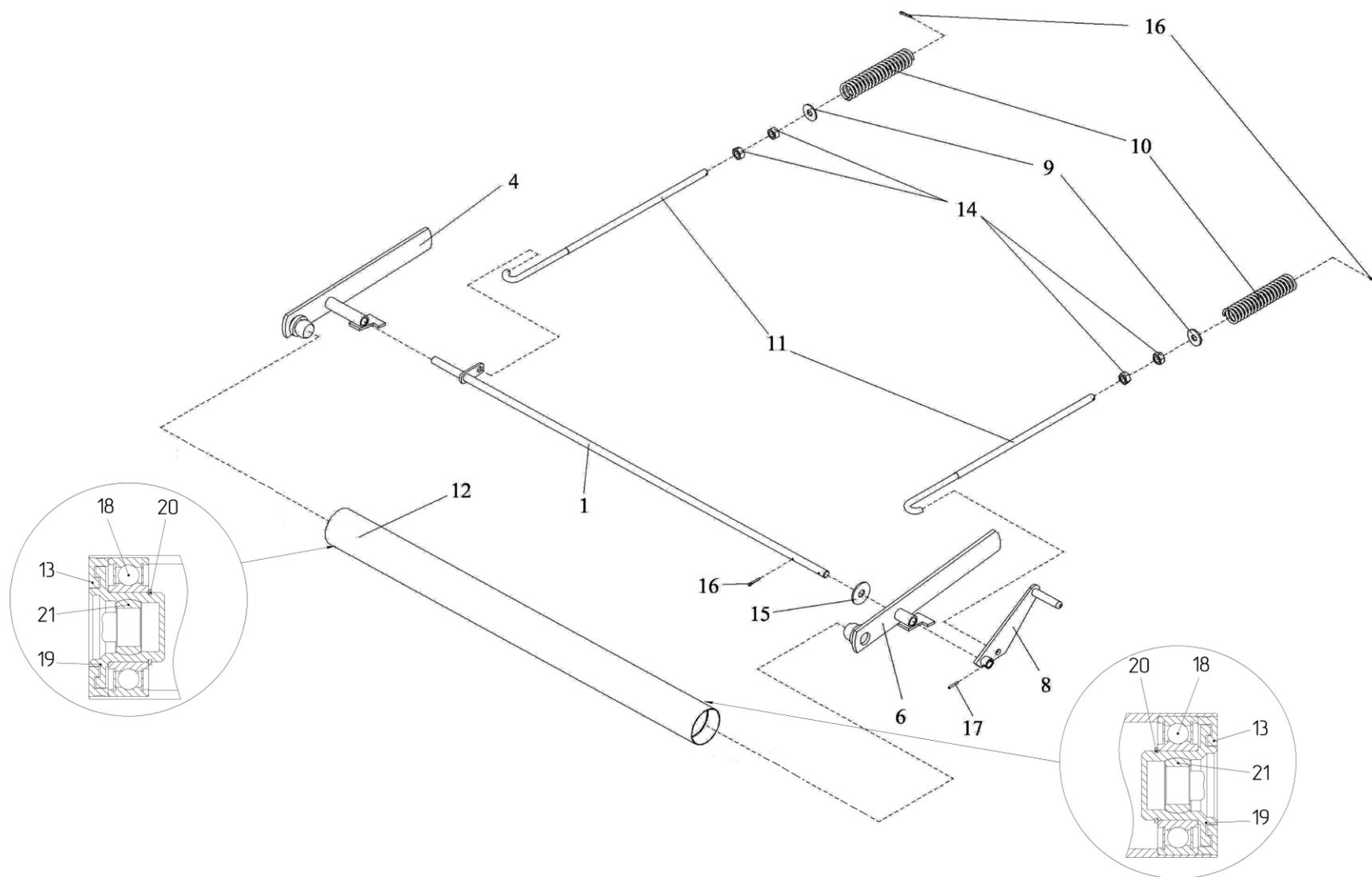
Рисунок 166 – Натяжное устройство ЖВЗ 1220000-01
