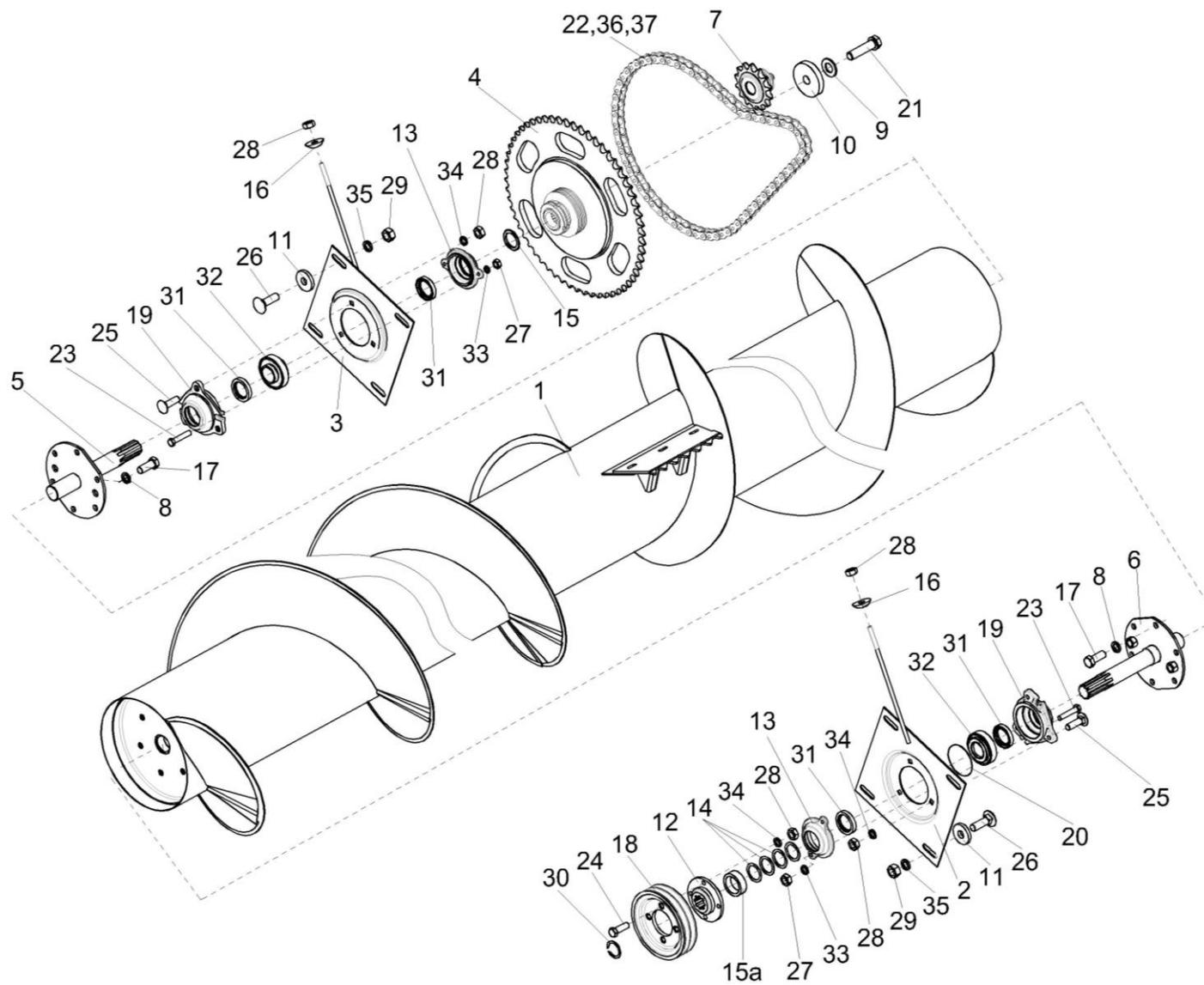
Рисунок 3 – Установка шнека
