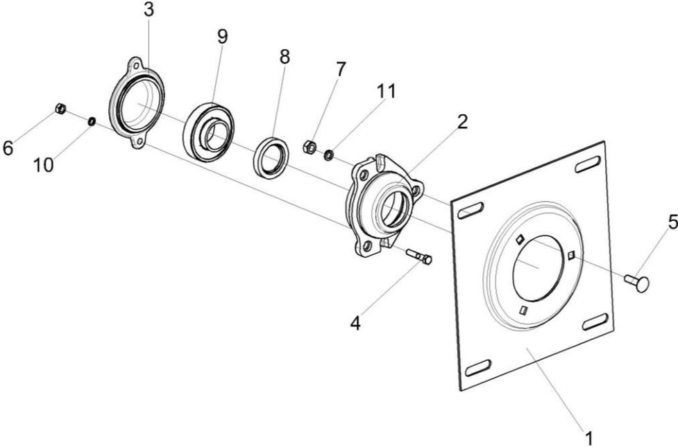
Рисунок 13 – Плита с подшипником КИС 0203050Б
