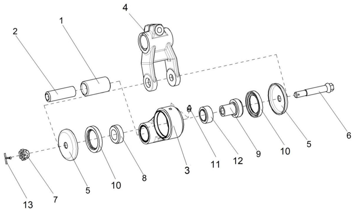
Рисунок 17 – Привод ножа КИС 0216020В
