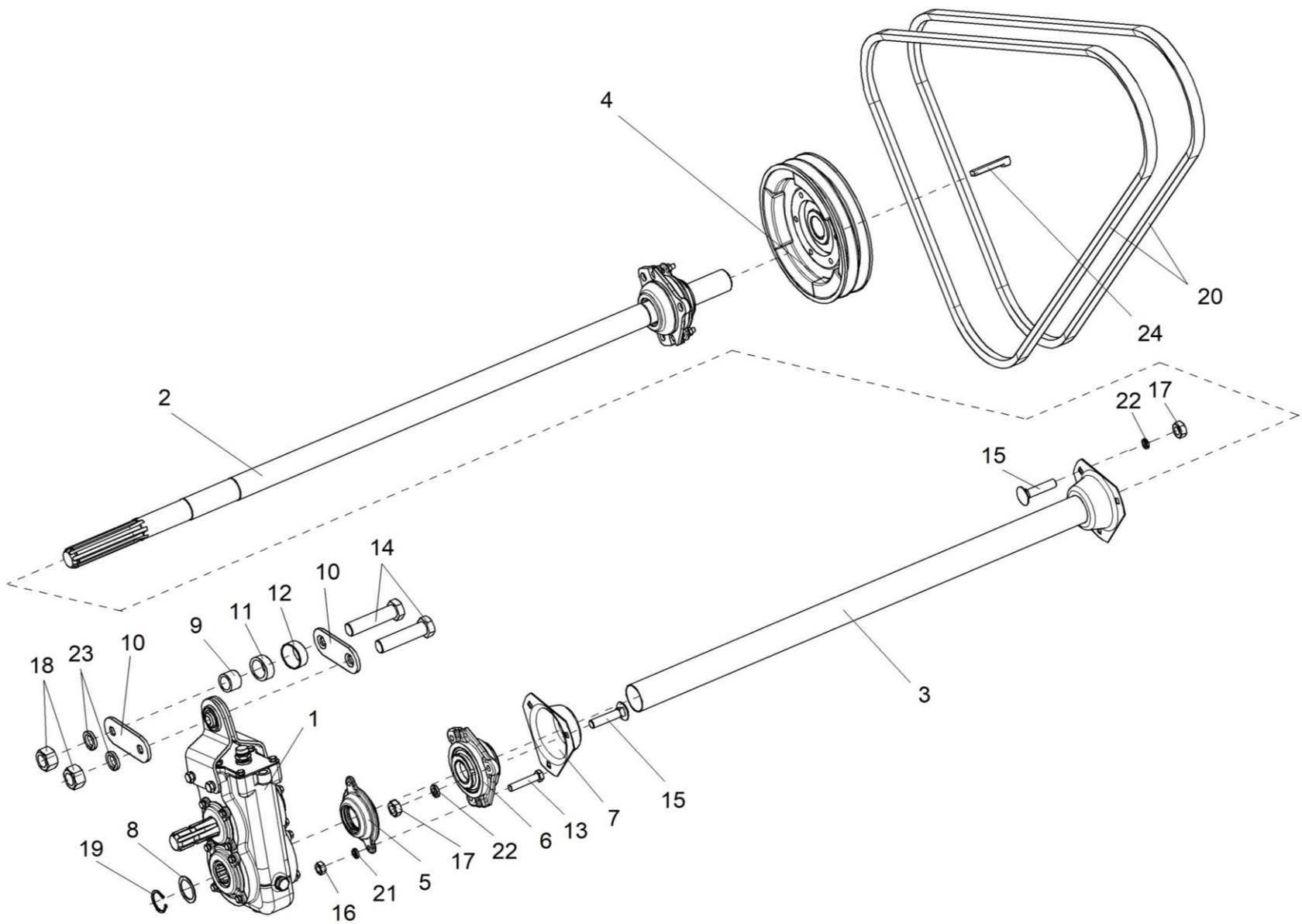
Рисунок 4 – Установка контрпривода
