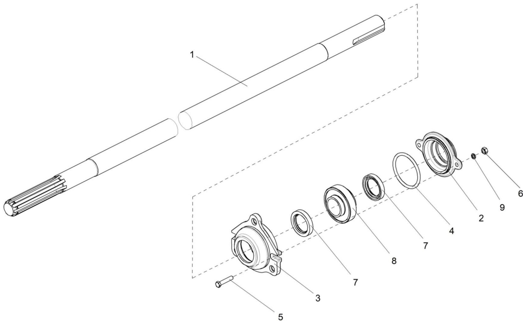
Рисунок 7 – Контрпривод КПТ 0464000
