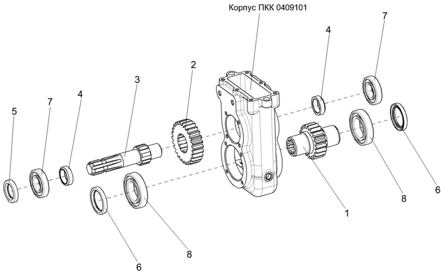
Рисунок 6 – Редуктор ПКК 0409000 (валы, шестерни)
