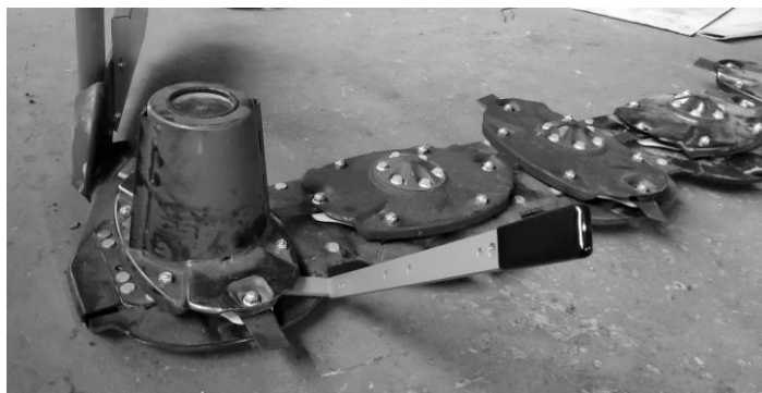
Рисунок 7.2 – Замена ножа (для быстросъемного режущего)
